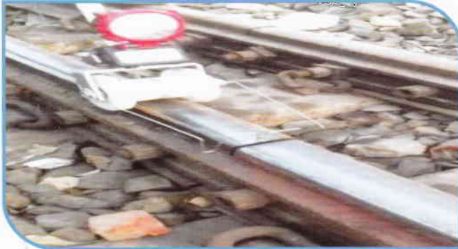
आद्रा मंडल द्वारा सभी प्रकार के रेल फ्रैक्चर का आसानी से सटीक रूप से और शीघ्र पता लगाने के लिए रेल / वेल्ड फ्रैक्चर डिवाइस बनाया गया है। अब नाइट पेट्रोलमैन को हेडलाइट लगे हेलमेट की भी जरूरत नहीं होगी।
